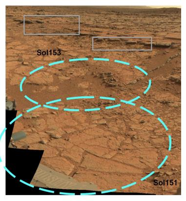
Участок Lower Sheepbed unit в районе Йеллоунайф Бэй. Кругами отмечены два типа поверхности, где прибор ДАН провел измерения в активном режиме. Распределение воды в грунте, относящемся к верхнему кругу, соответствует модели равномерного распределения с 2,5% содержания воды по массе. Данные, полученные для грунта в нижнем круге, соответствуют двуслойной модели с содержанием воды 1,4% по массе в верхнем слое (16 см) и 3,8% по массе — в нижнем. Фотография поверхности © NASA
