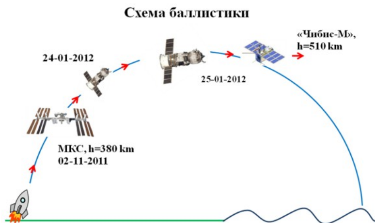
Рис.6. Схема выведения микроспутника на орбиту с использованием инфраструктуры Российского сегмента Международной космической станции (с) ИКИ РАН ***
