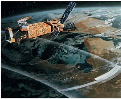
Рис.3. Общий вид одного из спутников серии DMSP (схематически показана подспутниковая полоса сканирования на поверхности Земли).
