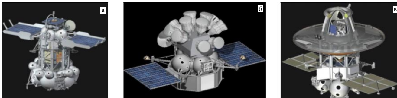
Рис. 21. Программа исследований Марса космическими аппаратами, разработанными НПО им. С.А. Лавочкина: (а) "Фобос-Грунт", задачи: доставка на Землю образцов грунта Фобоса, исследование околомарсианского пространства, исследование вариаций атмосферы Марса; (б) "Марс-Net", задачи: создание сети малых станций для исследований климата Марса и его внутреннего строения; (в) "Марс-Грунт", задачи: доставка на Землю образцов вещества с Марса.
